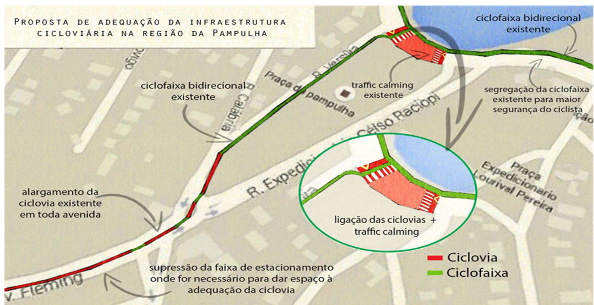
Fig. 6 Proposta esquemática para o tratamento da interseção entre a Rua Versília e a Avenida Otacílio Negrão de Lima
